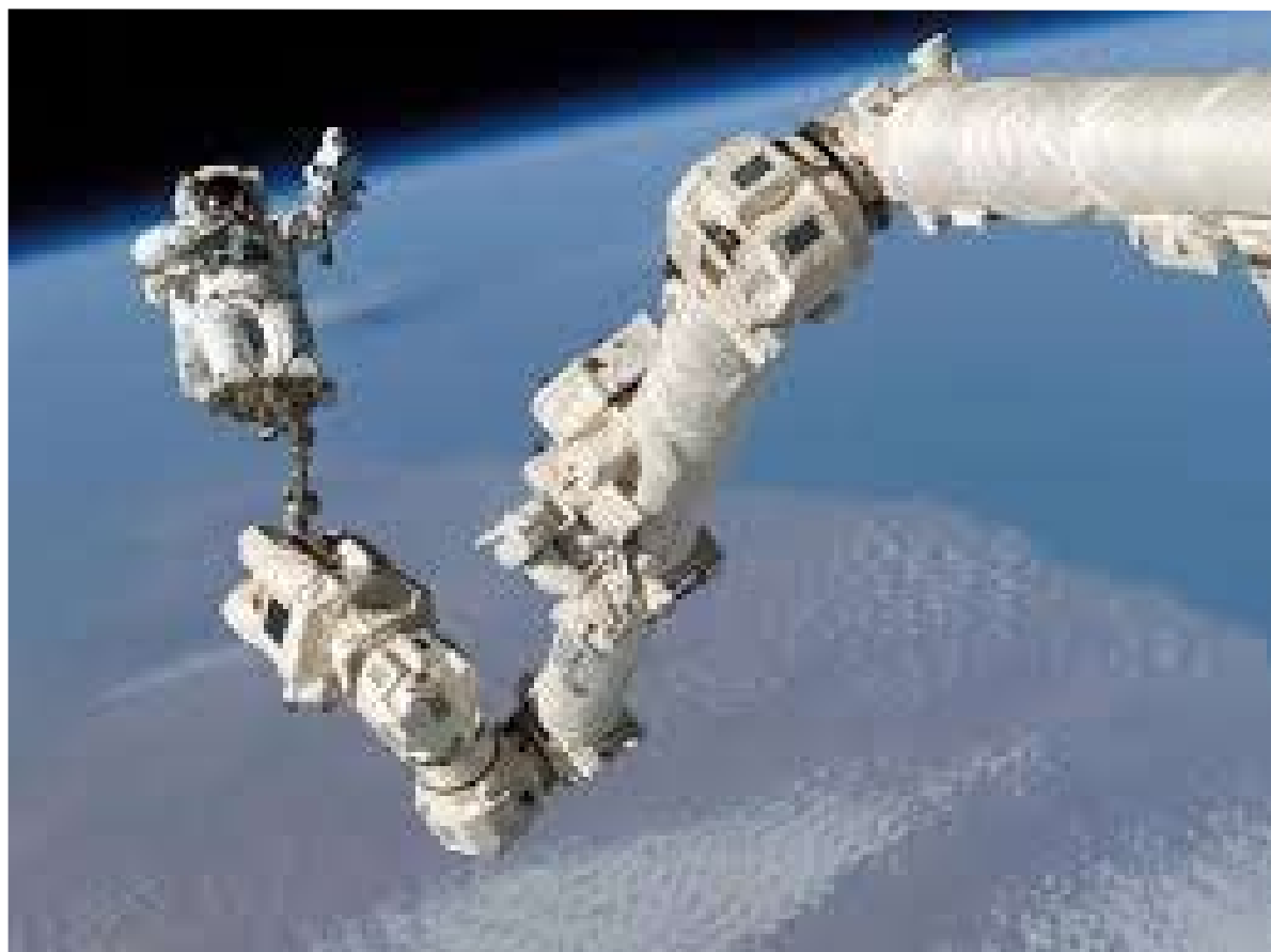
Εικ. 2 Η βιονική, χρησιμοποιεί πολλές από τις αρχές λειτουργίας των ρομπότ, απλά τα ρομπότ είναι απόλυτα προσαρμοσμένα για συγκεκριμένη εργασία και δεν χρειάζεται να έχουν (ούτε περιορίζονται από) ανθρωπομορφικά στοιχεία. Στη φωτογραφία, ο γιγάντιος ρομποτικός βραχίονας του Διαστημικού Λεωφορείου, με έναν αστροναύτη στην άκρη του.
