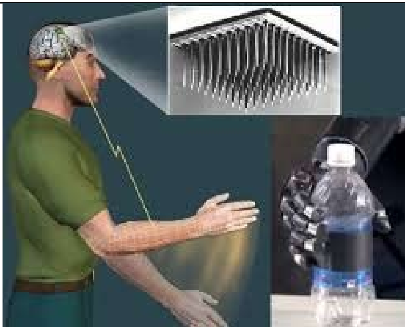
Εικ. 7 Εγκεφαλικό τσιπ της DARPA (σε επίπεδο νανοτεχνολογίας) που βρίσκεται σε ανάπτυξη σήμερα (αρχές του 2016), και θα πολλαπλασιάσει επί 10.000 τη διακριτική ικανότητα των σημερινών εμφυτευμάτων, επιτρέποντας πολύ λεπτομερέστερη επικοινωνία των προσθετικών άκρων με τον εγκέφαλο..
