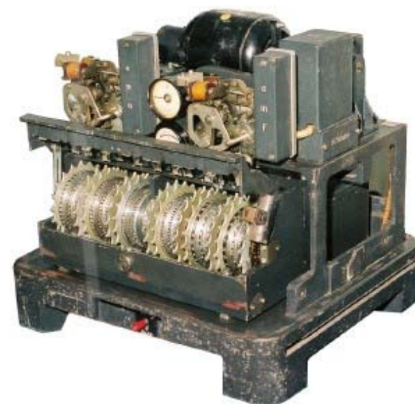
Εικ. 5 Η «Tunny», χωρίς το κάλυμμα και το πληκτολόγιό της. Φαίνονται οι δώδεκα τροχίσκοι που δουλεύουν σε ομάδες των 5 + 2 + 5. Φυσικά πρόκειται για γερμανική μηχανή (Lorenz) που βρέθηκε μετά τον πόλεμο, καθώς οι Βρετανοί ποτέ δεν κατάφεραν να αποκτήσουν μία κατά τη διάρκεια του πολέμου..
